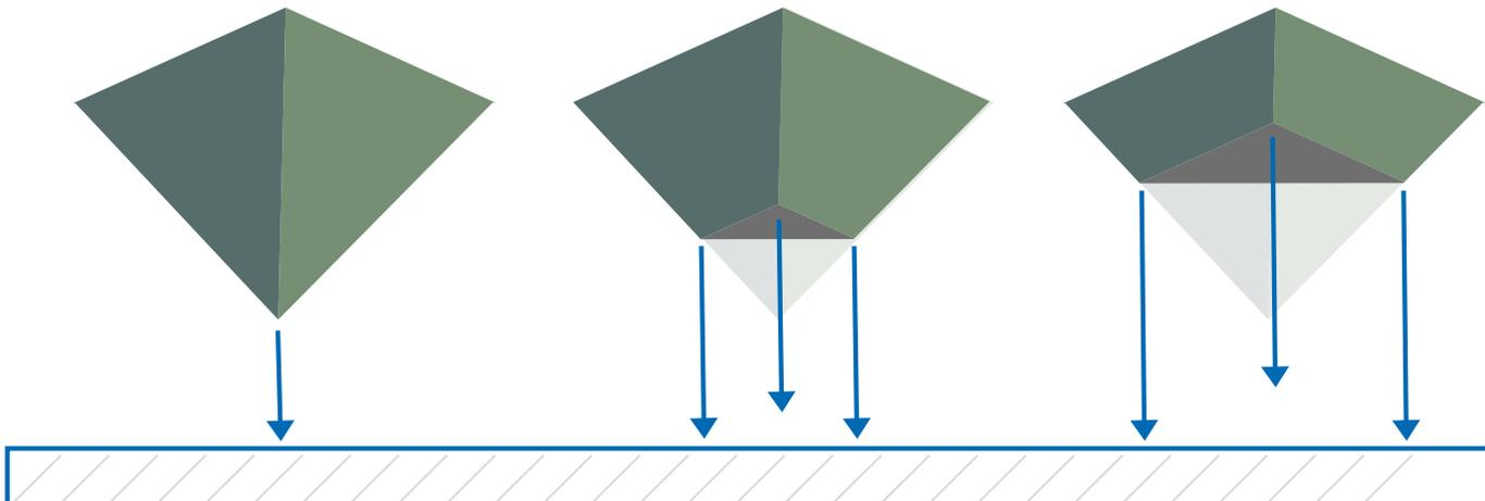
Die einzigartige Kornstruktur (regelmäßige Tetraeder) garantiert eine perfekt gleichmäßige Oberfläche bei der Verarbeitung sowohl frischer als auch vollständig ausgehärteter Decklacke.
