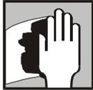
Vor dem Auftragen der Spachtelmasse muss die behandelte Oberfläche von Staub gereinigt und mit APP W900, APP W911 oder APP WB910 entfettet werden.
