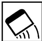
Mit einer Spachtel in dünnen Schichten innerhalb der Verarbeitungszeit, d. h. bis zu 5 Minuten, auftragen.
