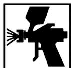
Mit einer Spritzpistole mit einer Düse mit einem Durchmesser von 1,2 bis 1,5 mm bei einem Luftdruck von 1,7 bis 2,1 bar auftragen.
