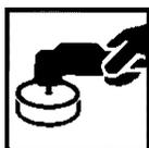
Nach 4 Stunden bei +20 °C können Fehler und Einschlüsse mit Schleifmitteln entfernt werden:
