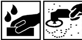
Nach 8 Stunden bei Temperatur von +20°C können Mängel und Einschlüsse mit Schleif- oder Poliermitteln entfernt werden:
