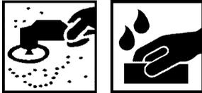
Vorhandene Oberfläche und Polyester-Produkte mit Schleifpapier P240-P320 glatt schleifen.
