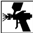
Mit einer Spritzpistole mit Düse  $\varnothing 1,2$ - $\varnothing 1,4$  mm bei einem Luftdruck von 2,0 bis 3,0 bar auftragen.
