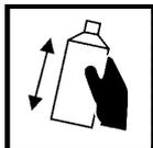
Rühren Sie die Grundierung durch Schütteln des Behälters für 2-3 Minuten gut auf.
