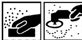
Entfernen Sie gründlich alle Korrosionsherde und schleifen Sie sie mit Schleifpapier P240-P320 trocken.
