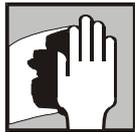
Reinigen und entfetten Sie die Oberfläche mit dem Antistatik-Entferner APP WK900 für Kunststoffe oder dem Entferner APP WB910.
