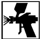
Mit einer Spritzpistole mit Düse  $\varnothing 1,3\text{-}\varnothing 1,5$  mm bei einem Luftdruck von 2,0 bis 3,0 bar auftragen.
