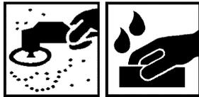
Nach 24 Stunden bei +20 °C ist es möglich, Defekte und Einschlüsse mit abrasiven Materialien zu polieren und zu entfernen:
