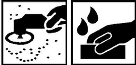
Nach 24 Stunden bei +20 °C ist es möglich, Defekte und Einschlüsse mit abrasiven Materialien zu polieren und zu entfernen:
