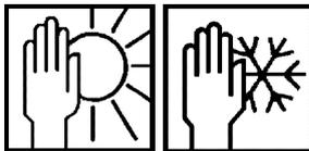
In verschlossenen Originalbehältern in einem trockenen und gut belüfteten Raum bei einer Temperatur zwischen +5 °C und +30 °C lagern.
