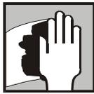
Vor Spritzen mit APP Lack PUR DTM 30-220 Satin die lackierte Oberfläche mit APP-WB910-, APP-W911- oder APP-W900-Abbeizmittel unter Anwendung des APP-Premium-Putzmittels von Staub befreien und entfetten.
