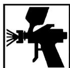
Mit einer Spritzpistole mit Düse  $\varnothing 1,3$ - $\varnothing 1,5$  mm bei einem Luftdruck von 2,0 bis 3,0 bar auftragen.
