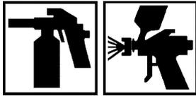
Mit einer Pistole für Wartung/Steinschlagschutz mit Struktur bei einem Luftdruck von 2-4 bar oder einer Lackspritzpistole mit einer  $\varnothing 1,5$ - $\varnothing 2,5$  mm Düse bei einem Luftdruck von 1,5 bis 2,2 bar auftragen.
