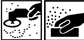
Die Oberflächen mit den werksoriginalen Anstrichen und Untergründen mit Schleifpapier P320-P360 trocken oder nass mit Schleifpapier P400-P600 schleifen.
