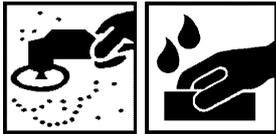
Nach 24 Stunden bei +20 °C muss vor dem Decklackieren mit Schleifsteinen geschliffen werden.
