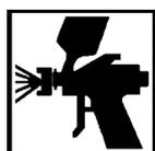
Mit einer Spritzpistole mit Düse  $\varnothing 1,6$ - $\varnothing 1,8$  mm bei einem Luftdruck von 2,0 bis 3,0 bar auftragen.
