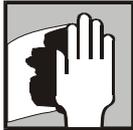
Vor dem Aufbringen der Dichtmasse APP PU 50 ist die Oberfläche zu trocknen, vom Staub zu reinigen und zu entfetten mit:
