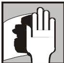
Vor dem Auftragen der Dichtmasse die Oberfläche trocknen, von Resten der alten Dichtung reinigen und entfetten:
