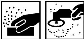
Alle Korrosionsherde von blanken Karosserieblechen entfernen. Teile aus Stahlblech mit Schleifpapier P120-P240 abschleifen, aus verzinktem Stahl, Aluminium und Kunststoff mit Schleifvlies sauber schleifen. Die Untergründe aus Acryl und Epoxid mit P360-P500 trocken schleifen.
