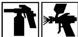
Mit Hilfe einer Aufsprüh-Wartungspistole und 2-4 bar Luftdruck oder einer Aufsprüh-Lackierpistole mit  $\varnothing 1,3$ - $\varnothing 2,0$  mm Düse und Luftdruck von 1,5 bis 2,2 bar auftragen.
