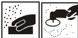
Alle eventuelle Roststellen genau reinigen und mit Schleifpapier P320-P400 trocken schleifen.
