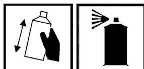
Mischen Sie die Grundierung gut, indem Sie den Behälter 2-3 Minuten lang schütteln. Führen Sie einen Sprühversuch durch. Bedecken Sie die bearbeitete Oberfläche gleichmäßig mit der Grundierung aus einem Abstand von 20-25 cm.
