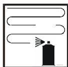
Anzahl der Schichten: mehrere dünne Schichten zur Abdeckung oder zum Erreichen der gewünschten Dicke.
