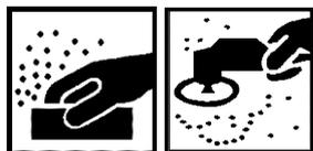
Entfernen Sie Korrosionsstellen gründlich und schleifen Sie sie mit Schleifpapier P320-P400 trocken.
