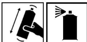
Mischen Sie den Inhalt der Packung gut, indem Sie den Behälter 1-2 Minuten lang schütteln. Führen Sie einen Sprühversuch durch.
