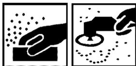
Entfernen Sie Korrosionsstellen gründlich und schleifen Sie sie mit Schleifpapier P80 trocken.
