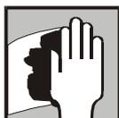
Vor dem Aufsprühen muss die zu schützende Oberfläche von Staub befreit und mit Entferner APP W900 oder APP BENZ entfettet werden.
