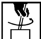
Die Becher sind für das manuelle, volumetrische Mischen von chemisch härtbaren Produkten mit Härtern in den in der Rezeptur angegebenen Verhältnissen sowie für die Einstellung der Sprühviskosität des fertigen Produkts mit organischen und wasserbasierten Verdünnern vorgesehen.
