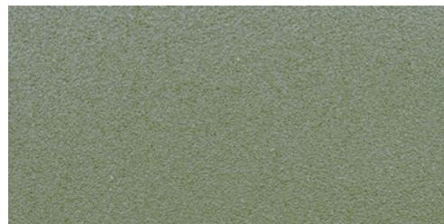
Um eine noch mattere Textur zu erzielen, sollte man nach der Auftragung der 2. Schicht (nach ca. 5 Minuten) eine weitere dünne Sprühschicht (s.g. Drop Coat) aus einer weiteren Entfernung auftragen.
