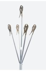
Der dritte Teil umfasst eine Klemme, also Hohlprofile aus Stahl mit Klemmzangen, die für stabile Klemmung von zu lackierenden Teilen sorgen. (APP-Nr. 170226)
