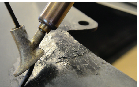
...und nach außen her biegen und mit dem Gerät in Kunststoff einbetten.
