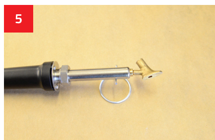
5 Vorbereitung des Schweißgeräts (an die Stromversorgung anschließen). Auf die Ablage abstellen.
