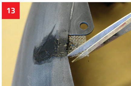
Den herausstehenden Teil des Netzes in Form eines „Briefumschlags“ zuschneiden...
