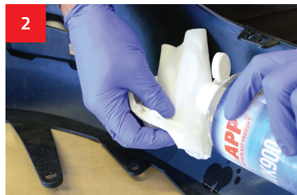
2 Vor der Reparatur die zu reparierende Oberfläche mit dem Mittel WK900 genau reinigen und entfetten.
