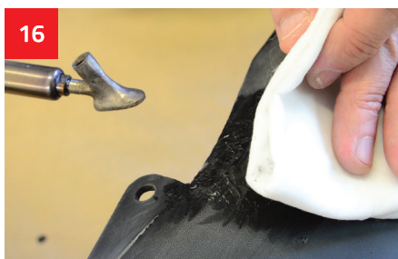
Wenn das Bindemittel zu schnell schmilzt, dann kann der reparierte Bereich mit einem im Wasser getränkten Tuch gekühlt werden.
