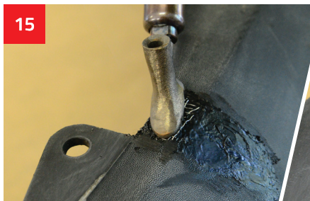
Das Bindemittel so einschweißen, dass das gesamte Aluminiumnetz bedeckt ist, die Oberfläche gleichzeitig endgültig formen.
