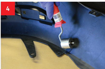
4 Mithilfe der im Set enthaltenen Rolle werden Unebenheiten und Verformungen geglättet.
