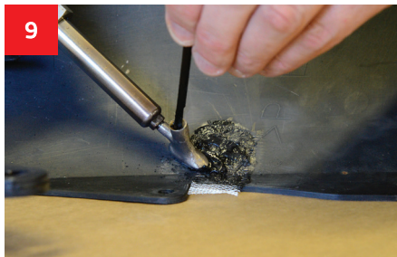
Das Bindemittel wird an der beschädigten Stelle an deren Innenseite der Beschädigung angeschweißt.
