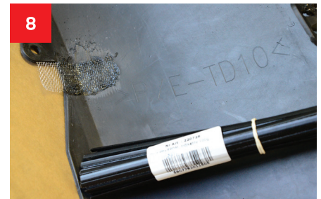
8 Ein an den zu reparierenden Kunststoff angepasstes Bindemittel wählen, um das Aluminiumnetz abzudecken und den reparierten Bereich zu verstärken.
