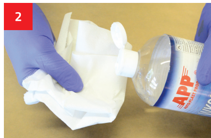
2 Vor der Reparatur soll die Oberfläche gereinigt und mit WK900 entfettet werden.
