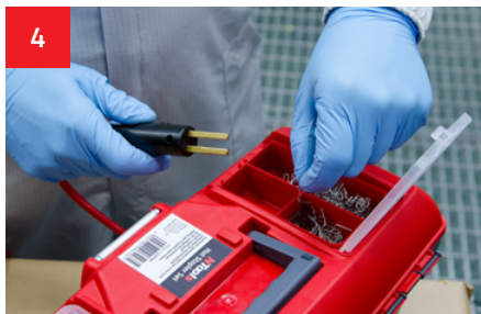
4 Geeignete Klammer für die zu reparierende Beschädigung auswählen.
