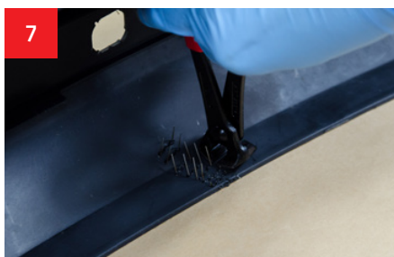
7 Die herausragenden Klammerdrähte werden mithilfe des Schneiders gekürzt.
