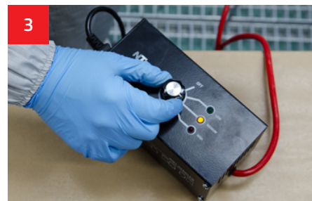
3 Ausreichende Leistungsstufe am Gerät Hot Stapler einstellen: Low, Medium oder High.
