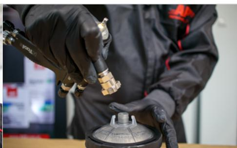
Après avoir peint, débranchez le tuyau d'air comprimé, retournez le pistolet, le godet étant dirigé vers le bas et pressez la gâchette du pistolet pour que la peinture sorte du pistolet et retourne dans le godet.
