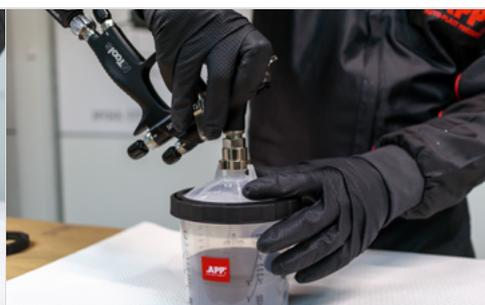
Sur le bec du godet en position debout mettez le joint FPS précédemment installé sur le pistolet et l'enfoncez totalement puis le tourner d'un quart de tour.
