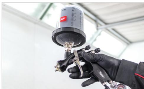
Pendant la mise de la peinture, il est possible d'utiliser le pistolet de pulvérisation à n'importe quel angle jusqu'à 180° inclus.
