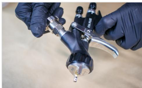
Fixez le joint FPS approprié sur le pistolet à peinture au joint du godet à gravité. Le raccordement doit être étanche et résistant mécaniquement.
