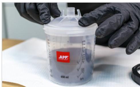
Placez le couvercle avec le filtre intégré sur le godet souple et appuyez à fond. La connexion avec le godet souple doit être étanche.
