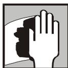
Avant d'étaler le mastic, la surface traitée doit être dépoussiérée et dégraissée avec le dissolvant APP W900, APP W911 ou APP WB910.
