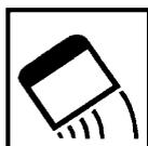
Appliquer à l'aide d'une spatule en fines couches pendant la période de conservation, à savoir dans environ 3 à 6 minutes. Température de travail recommandée : +15 °C à +25 °C. Ne pas utiliser le produit à des températures inférieures à +5 °C.
