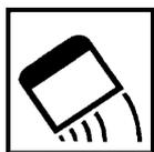
Appliquer à l'aide d'une spatule en fines couches pendant la durée de conservation, c'est-à-dire dans un délai d'environ 25 à 35 minutes à +20 °C.
