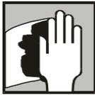
Avant d'appliquer le mastic, nettoyer la surface traitée de toute poussière et la dégraisser avec le nettoyeur APP W900, APP W911 ou APP WB910.
