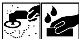
Après 24 heures à +20°C, il est possible de polir et éliminer les défauts et les inclusions avec des matériaux abrasifs :
