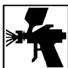
Appliquer avec un pistolet de pulvérisation muni d'une buse  $\varnothing 1,3$ - $\varnothing 1,5$  mm à une pression d'air de 2,0 à 3,0 bar.
