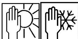
Stocker dans les emballages d'origine fermés, dans un local sec et bien ventilé, à des températures de +5°C à + 30°C.
