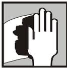
Avant l'application de la colle d'étanchéité APP PU 50, bien sécher la surface, la dépeussierer et dégraisser avec :
