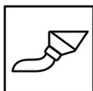
Dévissez le bouchon du tube et pressez la quantité nécessaire de mastic sur la surface du joint à étanchéifier.
