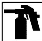
Bien mélanger le matériel dans le récipient en agitant, détacher la protection du bouchon et attacher le récipient au pistolet à peinture. Pulvériser avec un pistolet de pulvérisation conçu pour le maintien, sous la pression de 3,0 à 6,0 bar à une distance d'environ 30 cm à la température de +10°C à +25°C.
