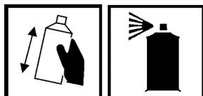
Bien mélanger la peinture en secouant le récipient pendant 2 à 3 minutes. Effectuer un essai de pulvérisation. Pulvériser uniformément la surface préalablement préparée à une distance de 20 à 25 cm.
