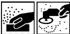
Enlever soigneusement toutes les taches de corrosion et poncer à sec avec du papier abrasif P320-P400.
