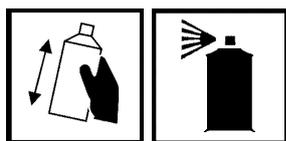
Bien mélanger l'apprêt en secouant le récipient pendant 2 à 3 minutes. Effectuer un essai de pulvérisation. Appliquer l'apprêt uniformément sur la surface à recouvrir à une distance de 20 à 25 cm.
