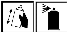
Bien mélanger le vernis en agitant le récipient pendant 2 à 3 minutes à partir du moment où l'on sent que les billes de mélange bougent. Effectuer un essai de pulvérisation. Pulvériser uniformément la surface préalablement préparée à une distance de 20 à 25 cm.
