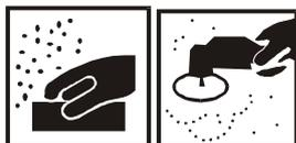
Enlever soigneusement toutes les taches de corrosion et poncer à sec avec du papier abrasif P320-P500.
