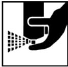
Afin de nettoyer la buse du vernis, retourner le récipient et activer l'aérosol pendant un moment. Le gaz propulseur va pousser le vernis restant hors de la buse, l'empêchant de sécher et permettant ainsi de réutiliser l'aérosol.
