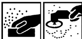
Enlever soigneusement toutes les taches de corrosion et poncer à sec avec du papier abrasif P80.
