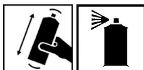
Bien mélanger le contenu de l'emballage en secouant le récipient pendant 1 à 2 minutes. Effectuer un essai de pulvérisation. Pulvériser uniformément la surface à protéger à une distance de 20 à 25 cm.
