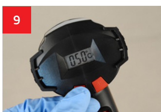
9 Sur le décapeur, sélectionner la température de soudage selon la matière.
