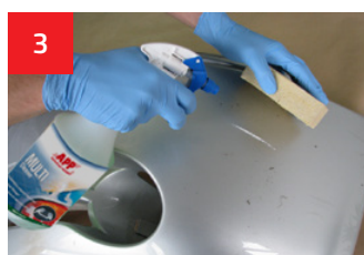
3 Décaper l'élément à réparer avec MULTI Cleaner dilué à 1:3 - 1:5.
