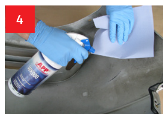
4 Dégraisser l'élément à réparer avec le dissolvant WK900.
