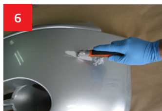
6 Enlever la peinture de la zone endommagée avec grattoir pour chanfreiner le plastique.
