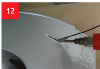
12 Du côté extérieur, souder la fissure en déplaçant la machine à souder le long de la fissure avec une vitesse qui permet de fondre les deux matériaux. Appuyer légèrement sur le fil avec le bout de la buse de soudage.
