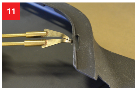
11 Masquez des extrémités faisant saillie avec un embout chauffé.
