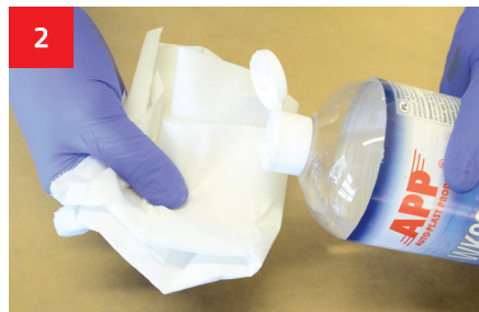
2 Avant commencer la réparation il faut nettoyer et dégraisser la surface avec WK900.
