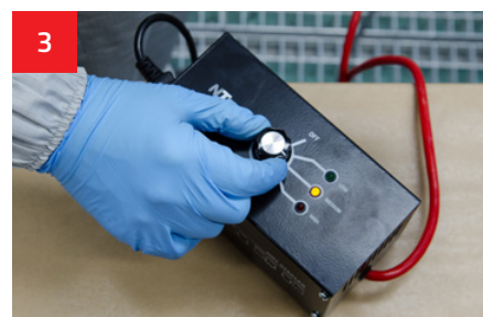
3 Sélectionner un bon niveau de chauffe avec Hot Stapler : Low, Medium ou High.
