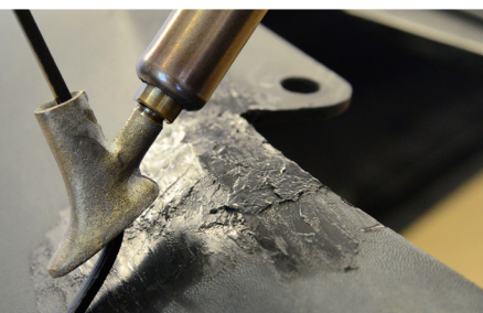
14 ... i zaginamy na zewnątrz zatapiając go w tworzywie za pomocą narzędzia.
