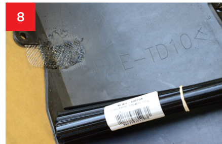
Aby ukryć siatkę aluminiową i wzmocnić naprawiany obszar dobieramy odpowiednie spoiwo do rodzaju naprawianego tworzywa.
