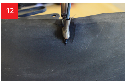
12 Spoiwo wtapiamy w uszkodzone miejsce modelując powierzchnię.
