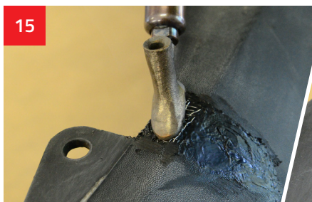
15 Wtapiamy spoiwo aby całkowicie zakryć siatkę aluminiową, ostatecznie modelując naprawianą powierzchnię.
