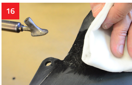
16 W przypadku zbyt szybkiego topienia spoiwa wystudzamy naprawiane miejsce przy pomocy ściereczki nasączonej zimną wodą.
