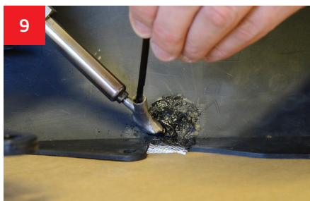
9 Spoiwo wtapiamy w uszkodzone miejsce po wewnętrznej stronie uszkodzenia.
