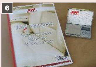
6 Z zestawienia NTW Receptury odczytać formułę mieszania pigmentów ustaloną w oparciu o numer wytypowanego koloru ze wzornika.
