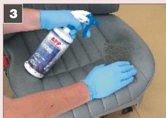
3 Obszar przemyć zmywaczem WK900 i szarą włókniną ścierną, co pozwala osiągnąć odpowiednie zmatowienie powierzchni.
