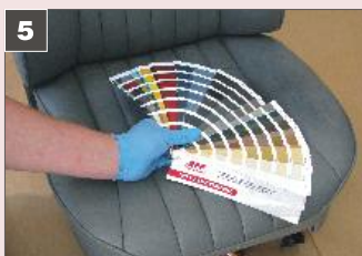
5 Ustalić kolor wykorzystując wzornik kolorów. Przy doborze należy zadbać o odpowiednie oświetlenie.
