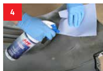
Odtłuścić naprawiany element zmywaczem WK900.
