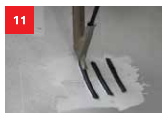
Wzmocnić naprawiany obszar, zgrzewając od wewnętrznej strony, prostopadle do pęknięcia, kilka pasków drutu do zgrzewania.
