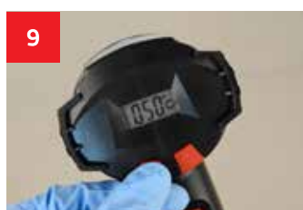
Na opalce wybrać temperaturę zgrzewania, do zidentyfikowanego tworzywa.
