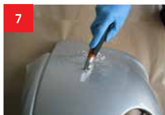
Naciąć fazkę „V” na pęknięciu, oczyścić, przedmuchać.
