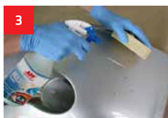
Wyczyścić naprawiany element używając np. MULTI Cleanera rozcieńczonego 1:3-1:5.
