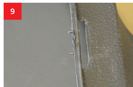
Wystające po przycięciu końcówki zszywek należy zszlifować (np. za pomocą szlifierki APP nr 139102).
