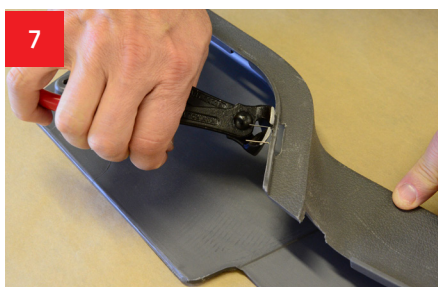
Wystające końcówki zszywek przycinamy za pomocą obcinaka.
