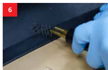
Zatapianie zszywek scalających uszkodzenie.
