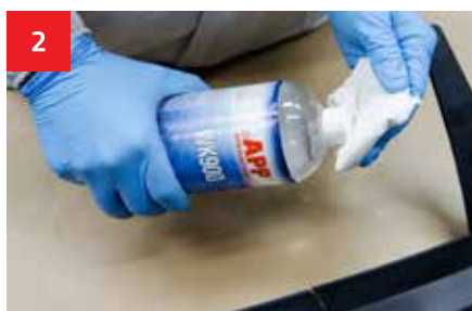
Przed przystąpieniem do naprawy należy wyczyścić oraz odtłuścić powierzchnię za pomocą WK900.
