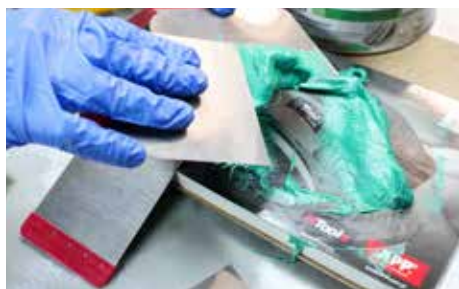
Смешивание шпаклевочной массы с отвердителем
